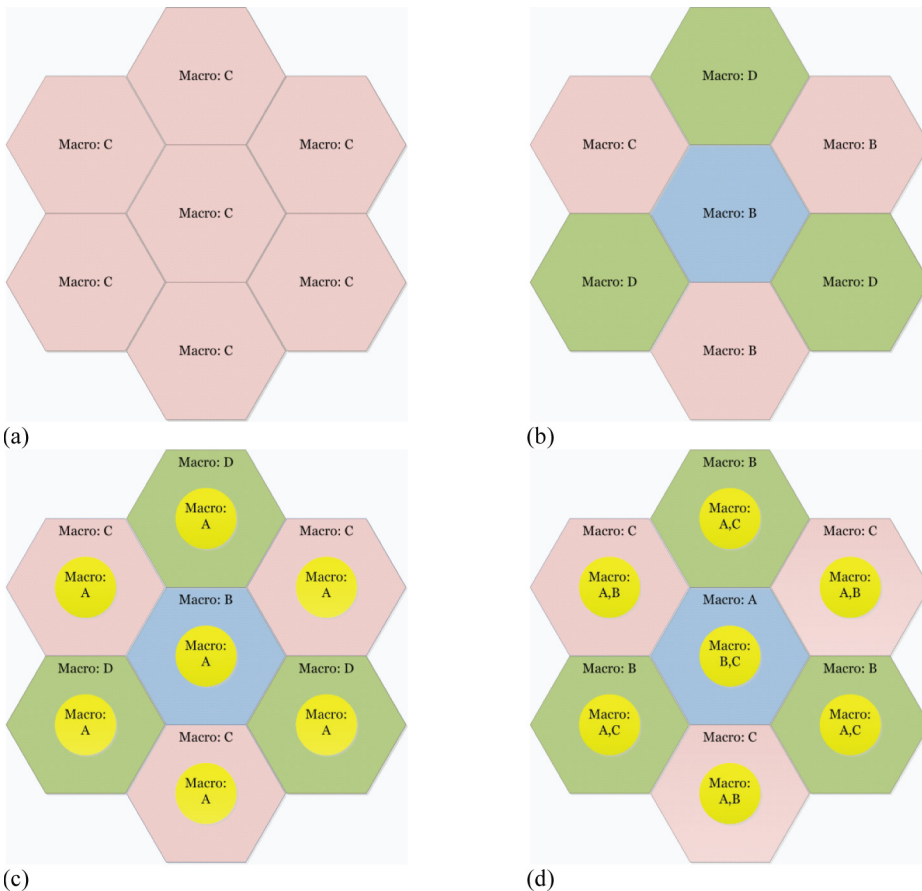
Figure 1. Frequency reuse in macrocellular environments: (a) IFR1, (b) IFR3, (c) FFR, (d) SFR
